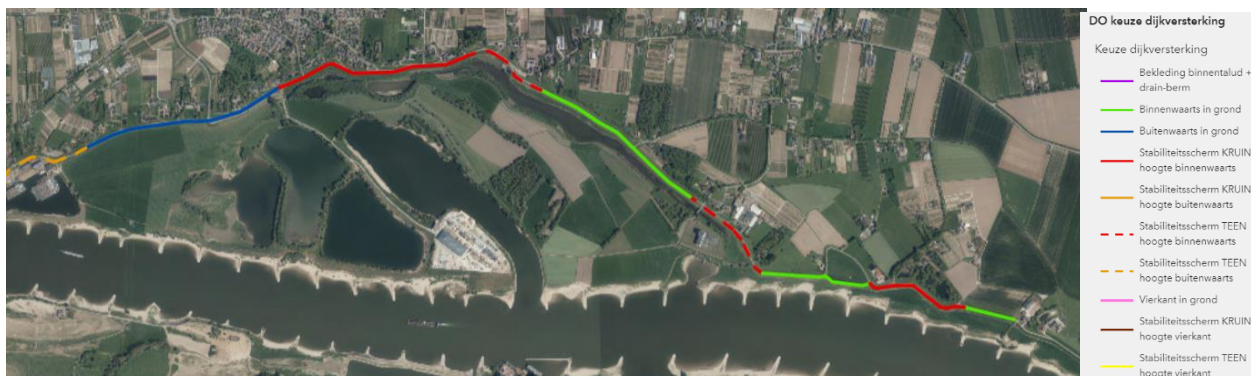
Figuur 2-2: Het dijkversterkingsontwerp DO – type versterking – voor Neder-Betuwe (van west naar oost) (15-11-2021)
