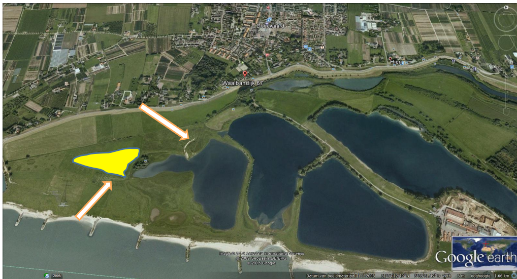
Figuur 3 Op bovenstaande luchtfoto is in het geel de af te graven terp aangegeven (ca 0,50 m afgraven naar een hoogte van 8,82m + NAP). De laagten liggen bij de peilen. In de laagte bij de meest zuidelijke peil zou ca 700-1000m 3 in kunnen en bij de andere peil zou ca 5000-8000m 3 in kunnen (@ Gemeente Neder-Betuwe).
