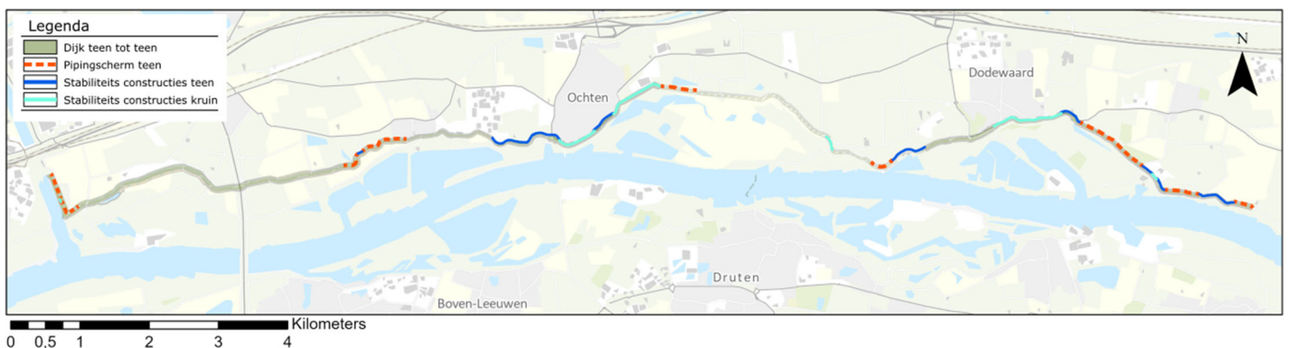
Figuur 4-10: Overzicht aan te brengen langsconstructies
