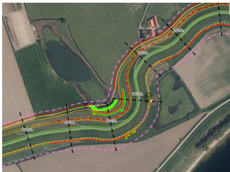
Figuur 5-18. Locatie bij Wiel ten westen van IJzendoorn waar opgaande vegetatie verwijderd zal worden en waar maatregelentegen graverij komen.
