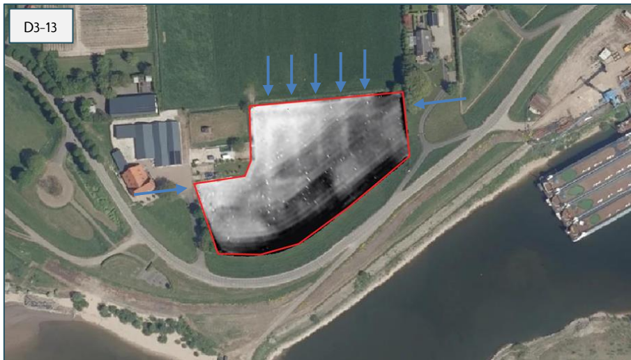
Afbeelding 40 Meetresultaten met EC-data van deeltraject 3-13. Bron: Saricon.
