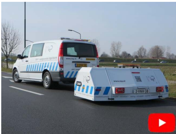
figuur 1 M+P CPX-trailer gedurende een meting
