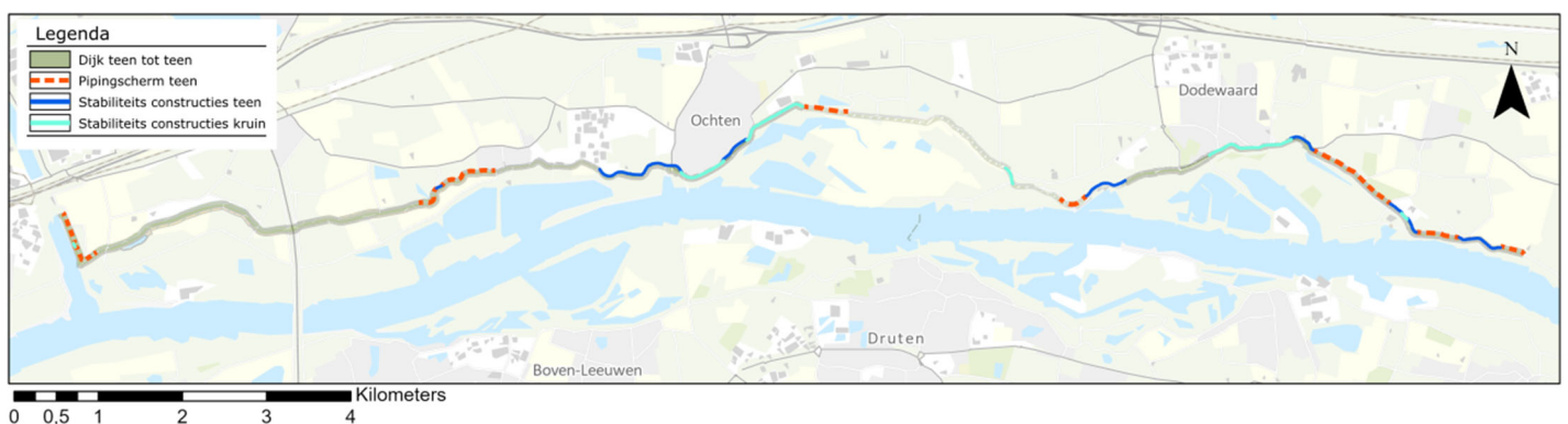
Figuur 4-10: Overzicht aan te brengen langsconstructies
