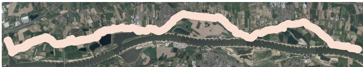
Figuur 4-2. Verstoringscontour van 150 m rond de werkzaamheden aan de dijk (licht oranje kleur).
