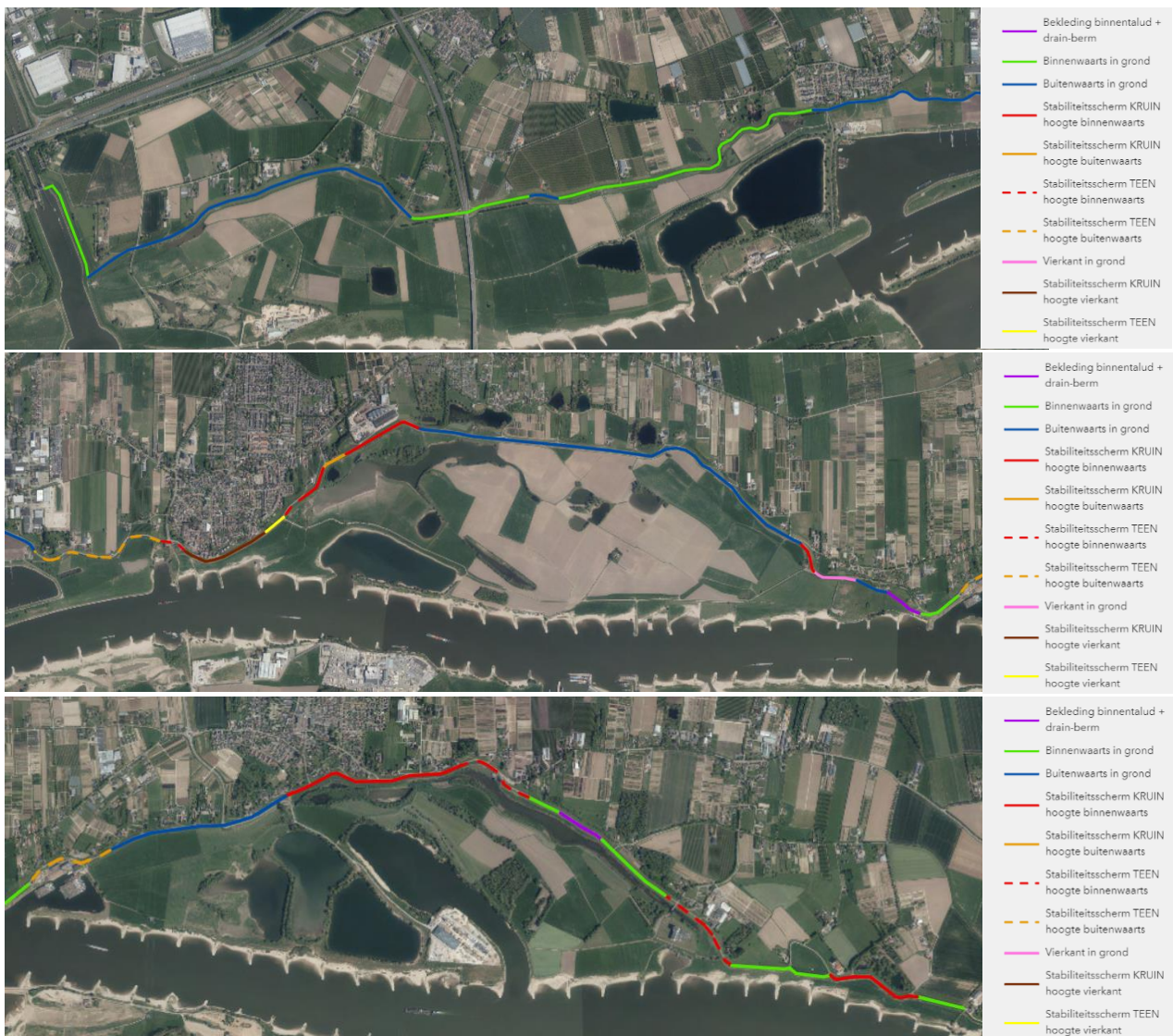
Figuur 4-1: Het dijkversterkingsontwerp DO – type versterking (van west naar oost)
